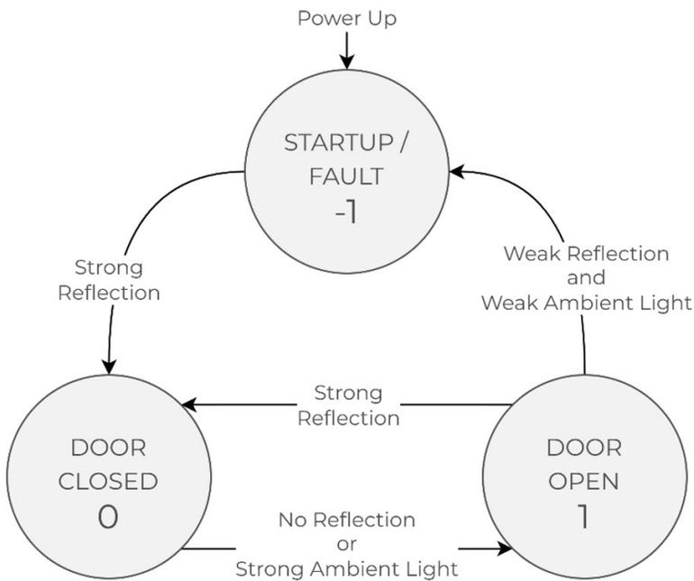
Figure E-1. CS211 door state diagram
