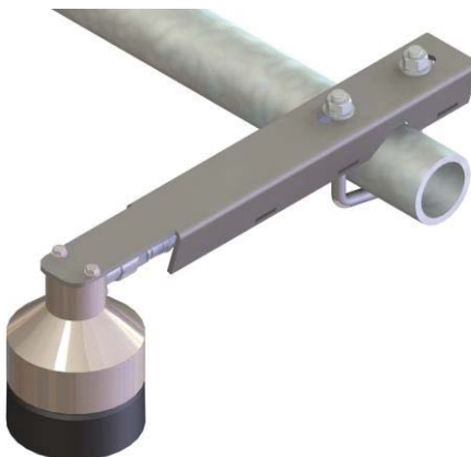
Figure 6 Montage du SR50A (n° de pièce C2169) - monté perpendiculaire au tuyau
