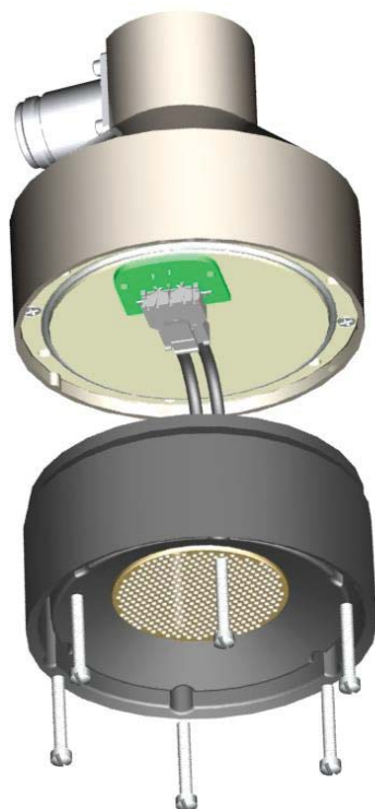
Figure 10 Enlever le boîtier du transducteur et débrancher les fils.
