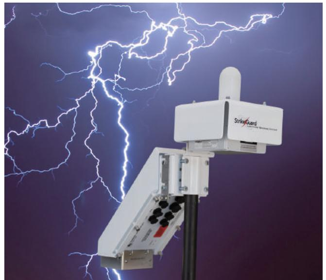
SG000 通过 FC100 光纤模块和光纤配件 (见上文) 与数据采集器、CS110 或 PC 端连接。
