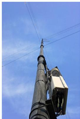
Ein auf einem Datenlogger basierendes System, montiert an einem MET Mast.
