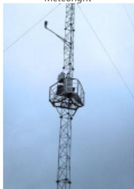
Sensoren werden an verschiedenen Punkten bis zur Nabenhöhe montiert
