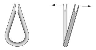
FIGURE 2-7. Thimble Twisting
