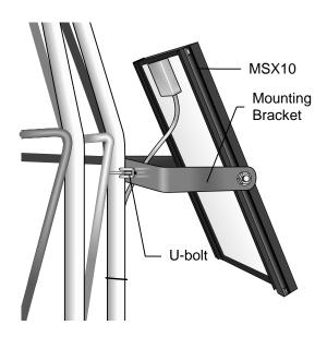
FIGURE 3.1-7. MSX10 Solar Panel on UT10 or UT30 Tower
