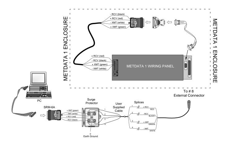
FIGURE 3.3-5. SRM-5A Wiring
