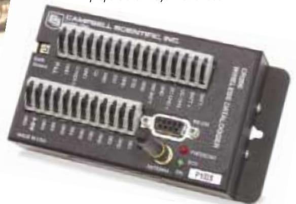
*Nuestra nueva serie de dataloggers CR200 combinan la robustez y bajo precio, con una radio spread-spectrum para proporcionar mayor flexibilidad.*
