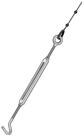
**FIGURE 2-8. Turnbuckle Assembly**
