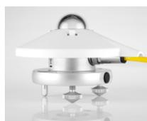
Le CMP3 est un pyranomètre ISO de seconde classe, qui mesure le rayonnement solaire global dans la gamme spectrale solaire complète. Il se connecte directement à une centrale de mesure Campbell Scientific, il est utilisé dans de nombreuses applications météorologiques et agrométéorologiques.
