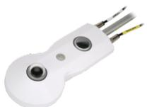
Le CNR4 est un capteur de rayonnement net destiné à la recherche, qui mesure l'équilibre énergétique entre le rayonnement entrant et sortant. Nos centrales d'acquisition de données mesurent les sorties du CNR4. Ce radiomètre net offre une solution professionnelle pour les études scientifiques en micrométéorologie, notamment pour le calcul du bilan d'énergie.
