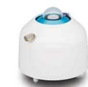
Le MS-80, fabriqué par EKO Instruments, est un pyranomètre secondaire standard de nouvelle génération, inspiré par la combinaison des dernières technologies et d'un capteur thermopile de pointe avec un décalage du zéro extrêmement faible, une réponse rapide du capteur et un intervalle de garantie et de réétalonnage de cinq ans.
