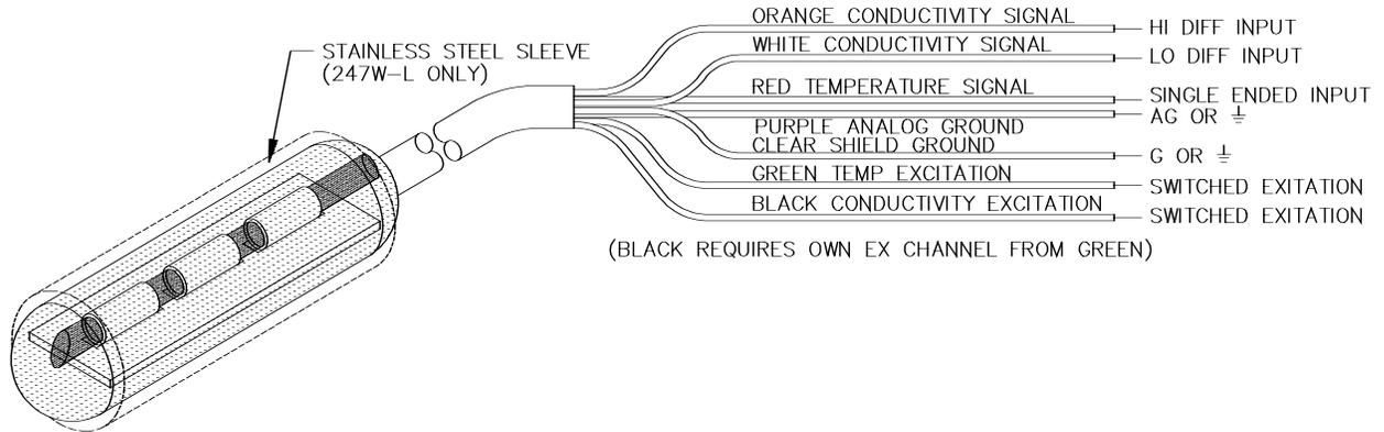
**FIGURE 4-1. 247 Wiring Diagram**
