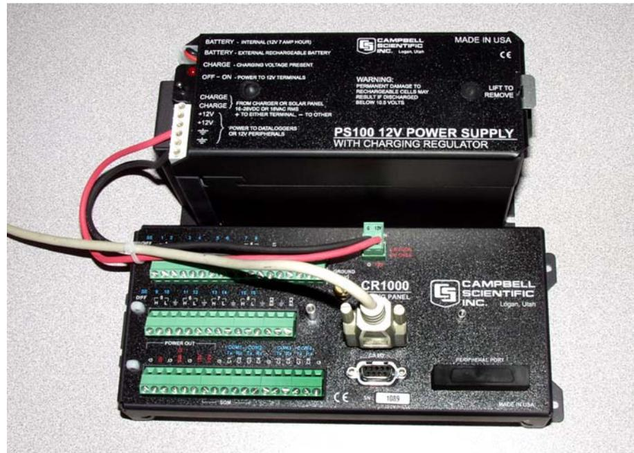
FIGURE OV4-1. Connexion de l'alimentation et de la RS232
