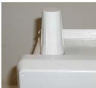
*2.4-ANT2 – Antenne résistante à l'eau montée sur un coffret de Campbell Scientific, 2.4 GHz 2.5dBi*
