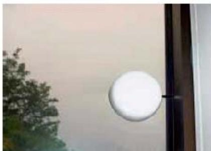
*2.4-ANT3 – Antenne pour passer à travers une fenêtre*
