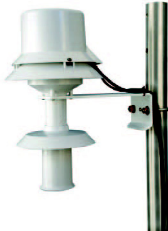
L'abri 43502 monté sur un tube vertical
