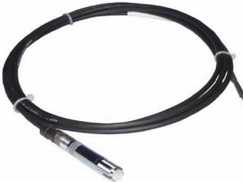
Le HMP50 fabriqué par Vaisala, mesure la température de l'air à l'aide d'une sonde platine 1000 ohms (TRP) et l'humidité relative à l'aide du composant capacitif INTERCAP®. Le composant est remplaçable sur site si besoin, ce qui élimine le temps nécessaire pour une procédure de réétalonnage. Le HMP50 remplace la sonde 50Y.
