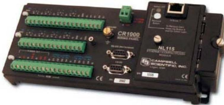
Ce NL115 est connecté au port périphérique d'une centrale de mesure CR1000. Le NL115 combine les fonctionnalités de notre interface Ethernet NL100 avec celle du module CompactFlash® CFM100.
