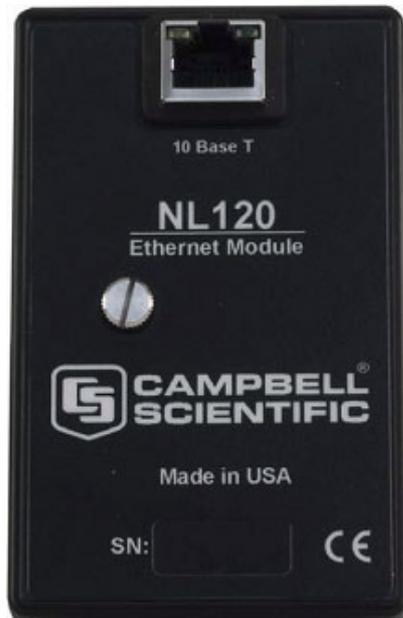
L'interface NL120 permet aux centrales d'acquisition de mesure de communiquer à travers un réseau local ou sur Internet via le TCP/IP. En utilisant l'écran Connect du logiciel LoggerNet, vous pouvez directement, envoyer et rapatrier un programme ou télécharger les données.
