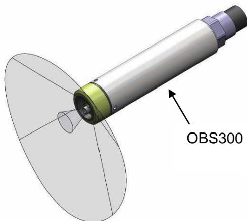
Ci dessus est représenté la lumière émise et le cône de détection de l'OBS-3+ et l'OBS300
