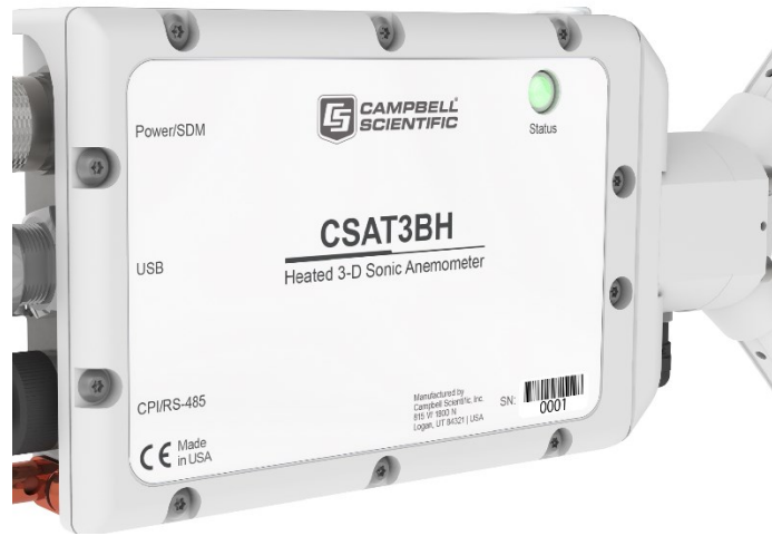
Figure 6-15. Lit status light on CSAT3BH block
