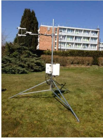
**Figure 5 : Photographie du mât avec l'IRGASON et les boîtiers d'acquisition**
